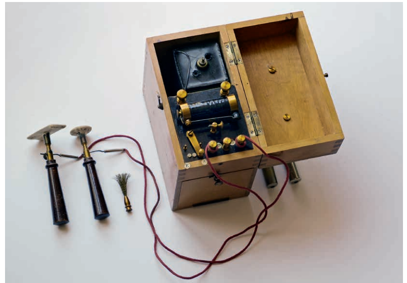
Reizstromgerät, Deutschland, um 1920, für medizinische Zwecke. Holzgehäuse mit Tragegriff und verschließbarem Seitenfach für Schraubgriffe und Elektroden. Material: Holz, Messing, Original-Trockenakku von Pertrix 1,5 Volt. Abmessungen: 17 x 17 x 10 cm. Im Bestand des PDZ Düren Foto: Eusebius Wirdeier
